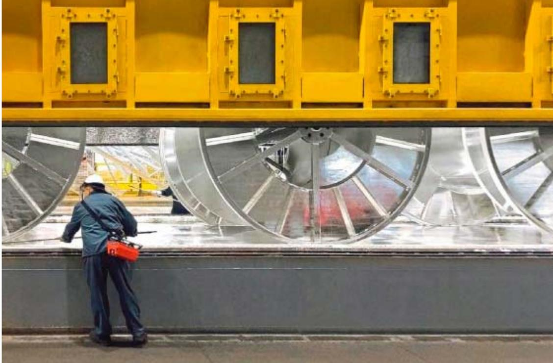
Die Feuerverzinkung dieser Spulen geschieht im Verzinkungskessel der Seppeler-Gruppe am Standort Holdorf – dem breitesten in Deutschland. Die Gruppe setzt den „eSaver“ bereits an drei ihrer elf Standorte ein, an denen sie Teile von Millimetern bis 23 m Länge verzinkt.
